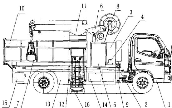
1. 一种多功能抓斗车,包括底盘,所述底盘的大梁安装副车架,其特征在于:所述副车架的前部依次安装水箱、工具箱,后部安装淤泥车厢,所述淤泥车厢前部的上端设有上料口,在所述副车架上位于上料口下方处设置自动提升机构;所述副车架上邻近工具箱处设置起重机构,所述起重机构的吊臂连接污泥抓斗,所述起重机构上部安装控制抓斗上液压油管收放的油管同步收放机构。
