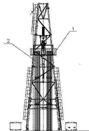
1. 一种垂直排管系统,该系统配套于传统井架钻机系统,钻机系统与该垂直排管系统直接配合的设备主要有井架、顶驱、铁钻工;其特征在于:所述垂直排管系统由指梁及风墙走道和铁架工组成;指梁及风墙走道由支撑架,风墙,走道,猴台,指梁体,指梁锁构成;指梁锁固定在指梁体上;指梁体、猴台、走道、风墙均固定在支撑架上;指梁及风墙走道通过支撑架固定在井架上;铁架工上端固定在猴台下端。
