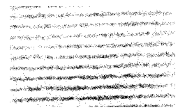
図2 ピッチ36nm(18nmライン)21.2mJ/cm 2
