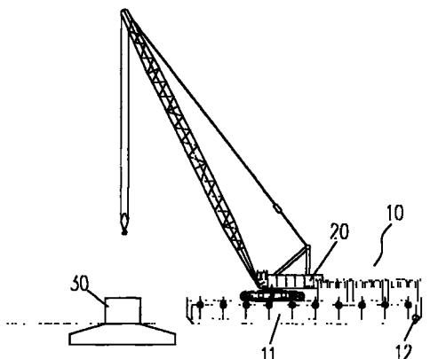
1. 一种潮间带风力发电机设备施工吊装方法,用于在潮间带区域将风力发电机设备运送到风力发电机基础位置上,主要包括以下步骤:
