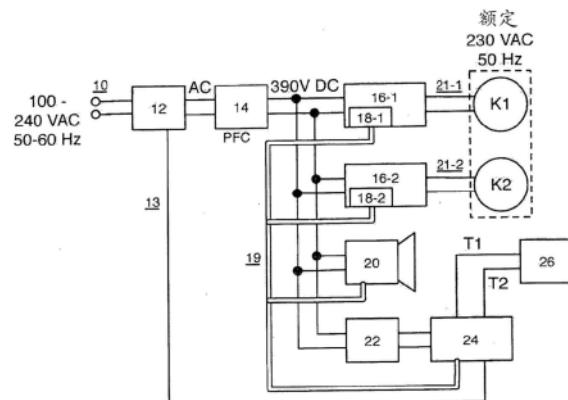
1. 一种冷却装置压缩机系统,所述冷却装置压缩机系统具有控制设备,所述控制设备用于具有两个两相的交流异步电机(K1、K2)的冷却装置压缩机,所述控制设备具有:
