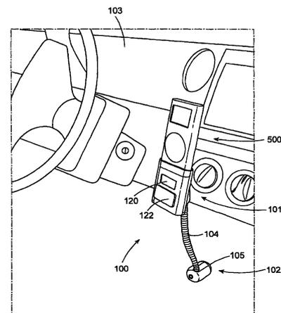
1. 一种保持器、电源和 RF 发射器单元，该单元用于保持电子装置，当将该电子装置保持在该单元中并且该电子装置正在工作时给该电子装置供电并从该电子装置中接收数据信号；该单元能将数据信号转换成 RF 信号并且将 RF 信号发射到 RF 接收器；当该单元正被使用时，能从外部电源到该单元地给该单元提供电能；该电子装置具有至少一个电能输入连接器和至少一个数据信号输出连接器，当将该电子装置保持在该单元中并且该电子装置正在工作时通过该电能输入连接器给该电子装置传送输入电能，当将该电子装置保持在该单元中且该电子装置正在工作时通过该数据信号输出连接器从该电子装置传送数据输出信号；该电子装置也具有顶部、底部和从该装置的底部朝向该装置的顶部延伸的底部部分；该单元包括：
