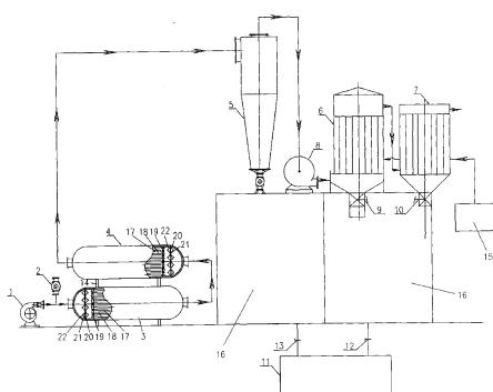
1、一种生物质电厂飞灰气力输送装置，其特征是：在动力风机（1）的输出端利用管道连接第一多孔输送器（3）并在所述管道上连接飞灰输入关风器（2），在第一多孔输送器（3）的输出端连接第二多孔输送器（4），所述第二多孔输送器（4）的输出端与旋风分离器（5）的输入端连接，在旋风分离器（5）的上端出口连接辅助动力风机（8），辅助动力风机（8）的输出端与脉冲除尘器（6）的输入端连接，所述脉冲除尘器（6）的输出端与布袋除尘器（7）连接；旋风分离器（5）、脉冲除尘器（6）及布袋除尘器（7）分离出来的飞灰落入储灰装置中，在储灰装置的底部设置卸灰装置（11）。
