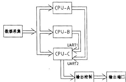
1、一种用于中央接口盘的冗余控制装置，其特征在于，包括数据采集单元，输入端口分别与所述数据采集单元连接的第一 CPU、第二 CPU 和监控 CPU，第一 CPU 的运算结果通过串行通讯口与监控 CPU 的第一 UART 口连接，第二 CPU 的运算结果通过串行通讯口与监控 CPU 的第二 UART 口连接，还包括与所述监控 CPU 的输出端口连接的输出控制单元以及与输出控制单元连接的输出端口；所述监控 CPU 这样提供信号给所述输出控制单元：如果来自第一和第二 CPU 的运算结果与监控 CPU 的运算结果一致，则输出运算结果到所述输出控制单元；如果第一 CPU 与第二 CPU 运算结果不一致，则按照监控 CPU 的运算结果对第一 CPU 与第二 CPU 运算结果进行“强制纠错”后将运算结果输出到所述输出控制单元；如第一 CPU 与第二 CPU 的运算结果完全一致而不同于监控 CPU 的运算结果，则系统放弃监控 CPU 的运算结果，属于控制“无效状态”。
