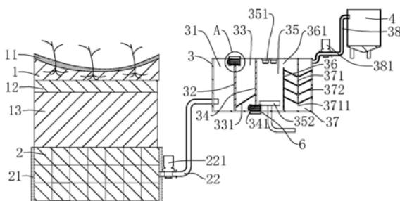
1. 一种市政道路下凹绿化带收水净水装置,其特征在于:包括自上至下依次设置的土壤层(1)、细沙层(12)和砂砾层(13),所述砂砾层(13)的下方设置有由若干蓄水模块拼接而成的蓄水区(2),所述蓄水区(2)的侧壁和底部均包裹有防水膜(21),所述蓄水区(2)连接有出水管(22),所述出水管(22)远离蓄水区(2)的一端连接有净化箱(3),所述净化箱(3)通过排水管(38)连接有集水箱(4)。
