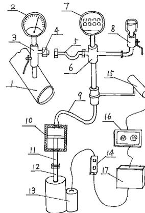
1. 一种便携式压力检测装置,其特征在于:在压力容器管路(1)和测量压力用的压力表、压力传感器、压力数字变送器压力测量元器件(2)之间安装一个三通阀(3),三通阀的检测一通和检测用的金属软管(5)相连接,金属软管和金属四通管件(6)的左侧一通相连接,金属四通管件的上一通和一个标准的压力表或数字检测表(7)相连接,金属四通管件右测的一通和一个开关阀(8)相连接,金属四通管件的下一通用一根通气管(9)和气缸(10)的出压孔相连接,气缸的缸杆(11)和电动推拉杆(12)相连接,电动推拉杆带动气缸缸杆可进行伸缩运行,电机带动推拉杆的正反向运行是用手控的正反向开关(14)来控制电源(17)的极性变化来实现的。
