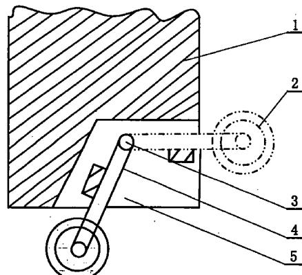
1. 一种带收缩轮的桌腿，该带收缩轮的桌腿主要由轮子(2)、铰接轴(3)和支杆(4)组成；其特征是：在桌脚(1)的下部设有凹槽(5)，凹槽(5)上设有铰接轴(3)，铰接轴(3)顺序连接着支杆(4)和轮子(2)，支杆(4)可以水平固定在凹槽(5)上部，也可倾斜支起桌脚(1)。
