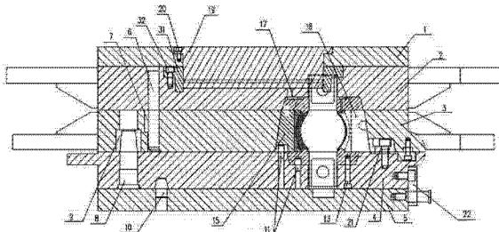
1. 牵引电机球铰四腔模具，包括上模、中模、底模以及底模垫板，其特征在于，上模、中模、底模以及底模垫板的对应位置上开有四个工作腔，工作腔内设置有上模镶块、底模镶块，并在工作腔的中模位置侧旁的三瓣模旁设置有隔片，同时，在所述上模上还设置有一个注胶塞固定板，此注胶塞固定板上设置有与工作腔位置相对应的开孔，并在上模的上表面上开有一个与注胶塞固定板上开孔的孔径大小一致的注胶孔，注胶孔底部与工作腔连通，另外，在注胶孔处还设置有一个注胶塞，注胶塞位置与注胶塞固定板上表面等高。
