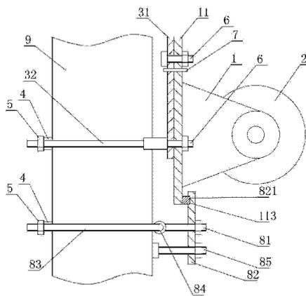
1. 支架式机动绞磨,包括底座、绞盘,所述绞盘设于所述底座上,其特征在于:还包括主支撑架,所述主支撑架包括连接板、主直角连接件,所述主直角连接件包括互成直角交叉的两根主连接杆,所述主直角连接件固定于所述连接板的一侧面上并使得其中一根主连接杆与该侧面垂直,所述主连接杆上设有紧固件,所述连接板通过两个螺栓与所述底座的底板固定连接。
