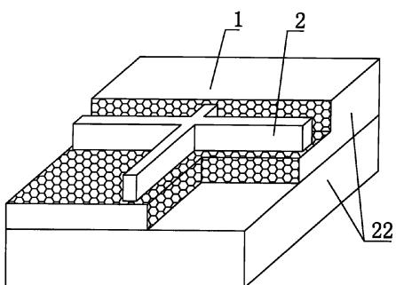
1、一种现浇砼用轻质胎模构件，包括多面体实心轻质材料构件（1），多面体实心轻质材料构件（1）是由两块实心胎模构件（22）组合构成的整体，其特征在于所述的多面体实心轻质材料构件（1）内含有至少一片加劲肋板（2）。
