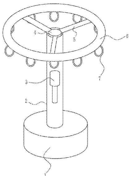
1. 一种新型毛笔笔挂,其特征在于,包括有底座(1)、空心杆(2)、旋转装置(3)、第二转轴(4)、连接杆(5)、环形圈(6)和挂环(7),底座(1)顶部中心设有空心杆(2),空心杆(2)上设有旋转装置(3),旋转装置(3)上设有有第二转轴(4),第二转轴(4)上部设有连接杆(5),连接杆(5)外端连接有环形圈(6),环形圈(6)底部设有挂环(7)。
