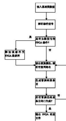
1. FPGA 约束文件自动生成系统,其特征在于:包括数据解析运算单元及与之连接的原理图数据检入单元、FPGA 器件参数数据库、FPGA 约束文件生成单元;所述原理图数据检入单元用于检入原理图网络互联拓扑数据及原理图中的器件位号;所述数据解析运算单元首先区分 FPGA 器件与其它器件的位号,其次,根据 FPGA 的器件位号来关联与 FPGA 器件互联的网络,再按照既定规则解析出与 FPGA 器件各个管脚连接的有效网络名,并根据命名规则解析出与管脚属性相关信息,最后,以解析出的网络名所包含的管脚属性相关信息与 FPGA 器件参数数据库进行关联,根据已制定好的规则选取 FPGA 器件参数数据库中管脚的约束条目;所述 FPGA 器件参数数据库负责提供 FPGA 器件的相关参数;所述 FPGA 约束文件生成单元根据数据解析运算单元的运算结果按照输出规范输出 FPGA 约束文件。
