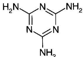
によって表わされているメラミンは、カルボニル基含有化合物との反応によってメラミン樹脂を製造するために使用される。この樹脂は、なかんずくプラスチックならびに塗料およびワニスに使用されている。尿素の分解によるメラミンの製造は、公知反応であり、この公知反応は、多種多様に化学工業によって利用されている。原理的に高圧法と低圧法とは、区別される。高圧法は、約80バール超（絶対）の圧力および370超の温度で触媒の不在下に実施される。
