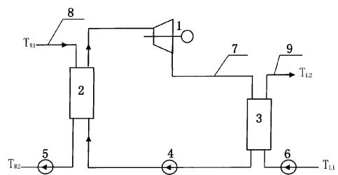
1. 一种利用低沸点工质的双循环螺杆膨胀动力机系统，其特征在于，包括有：螺杆膨胀机（1）、蒸发器（2）和冷凝器（3），其特征在于，所述的螺杆膨胀机（1）、蒸发器（2）和冷凝器（3）通过密封管路依次连接形成一工质循环通路（7），所述的蒸发器（2）上设置有用于加热工质循环通路（7）内所循环流动的工质的加热通路（8），所述的冷凝器（3）上设置有用于冷却工质循环通路（7）内所循环流动的工质的冷却通路（9）。
