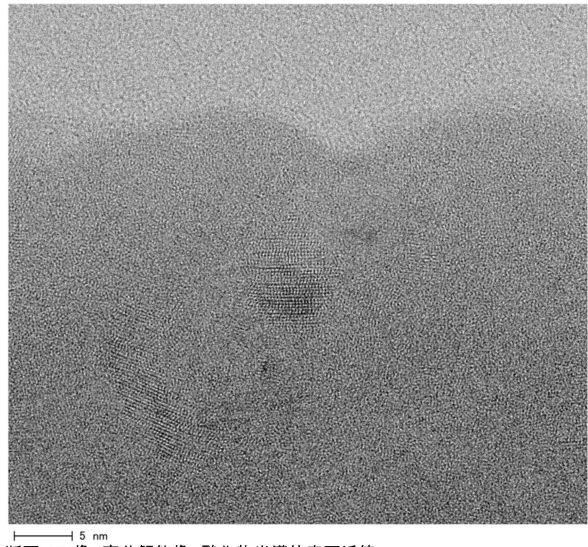
断面TEM像 高分解能像 酸化物半導体表面近傍
