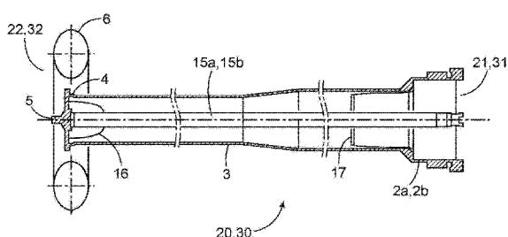
1. 一种形成纯气体技术制造的高压交流 (AC) 或直流 (DC) 穿壁套管的一个部段的插头式模块 (20)，所述插头式模块 (20) 包括绝缘管 (3)，所述绝缘管 (3) 在所述插头式模块的第一端部处通过布置在所述插头式模块的第一端部 (21) 处的中心凸缘部分 (2a) 的内部管状部段轴向地延伸，所述绝缘管 (3) 和所述中心凸缘部分 (2a) 包围中心柱形导体 (15a)，所述导体沿所述插头式模块轴向地延伸，所述插头式模块在其第二端部 (22) 处具有密封所述插头式模块并且支撑所述中心导体的凸缘 (4)，所述插头式模块被设计为通过利用插座式模块的中心凸缘部分 (2b) 可逆地密封所述插头式模块的中心凸缘部分 (2a) 并且通过将所述插头式模块的中心导体 (15a) 可移除地连接到所述插座式模块的中心导体 (15b) 而电气性地接插到所述插座式模块 (30) 中，所述插座式模块 (30) 形成了纯气体技术制造的高压交流或直流穿壁套管的另一部段。
