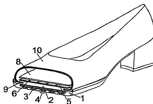
1. 一种可拉伸的鞋底，用于硬质鞋底的基底（1）胶合在鞋帮（10）的边缘上的那种类型的鞋子，其特征在于，所述鞋底包括一个基底（1）和一个插入件（2），所述插入件（2）可横向拉伸，且在其下表面上设有一个或多个凸出部（3），通过模制弹性材料来制成所述插入件（2），并将所述插入件（2）通过注射来胶合或接合在所述基底（1）上，所述基底（1）的前部设有一个或多个开口（4），所述凸出部（3）密封地埋入其中。
