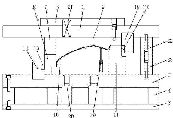
1. 汽车发动机排气系统出气锥管壳体的翻边模具，其包括上模结构与下模结构，所述上模结构包括上模板，所述上模板上安装有上模脚，所述下模结构包括下模板，所述下模板下通过下模脚安装有下安装板，所述上模板与下模板之间安装有独立滑动导向机构，所述上模结构与下模结构通过所述独立滑动导向机构导向合模，其特征在于：所述上模板下安装有组合式翻边成型凹模，所述下模板上安装有组合式翻边成型凸模，所述组合式翻边成型凹模与组合式翻边成型凸模将工件压紧后翻边到位。
