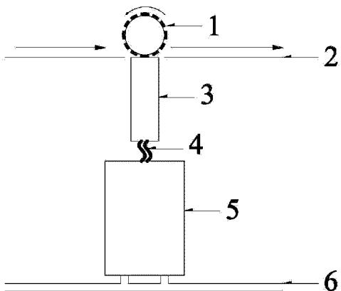
1. 一种集装袋裁剪折边机折边装置,包括碾压滚轮(1)、台面(2)、电热棒(3)、连接导线(4),碾压滚轮(1)设置于电热棒(3)上方,其特征在于电热棒(3)通过连接导线(4)与超声波发射器(5)连接。
