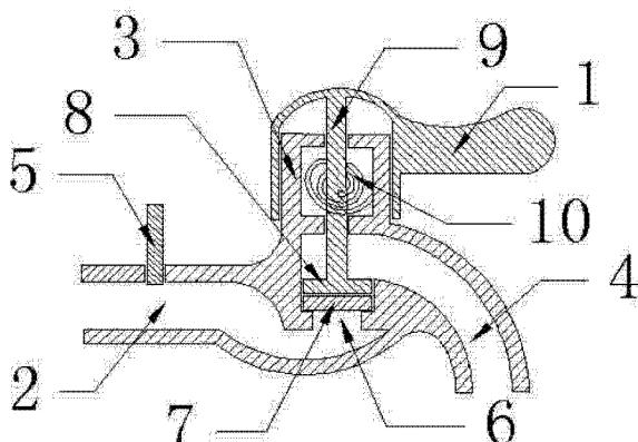
1. 一种自动关闭式水龙头,包括安装在一起的进水管(2)、出水管(4)、阀体(3)和手柄(1),其特征在于:进水管(2)的管口设有与室内输水管道相配合的外螺纹;阀体(3)内设有连通进水管(2)和出水管(4)的阀门(6),阀门(6)安装有挡板(7),挡板(7)上端安装有转子(8),转子(8)上端与转轴(9)相连,转轴(9)一端与套在阀体(3)上的手柄(1)相连;转轴(9)与阀体(3)之间安装有发条(10)。
