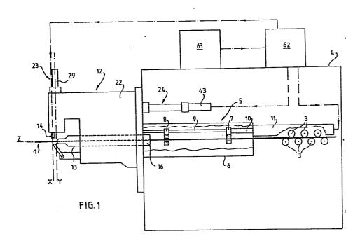
Machine automatique pour cambrer selon une configuration spatiale, des éléments minces et rectilignes, et notamment des fils métalliques
