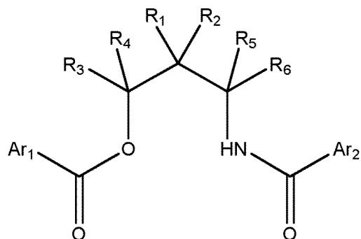
où  $\text{R}_1$  à  $\text{R}_6$  sont identiques ou différents, chacun de  $\text{R}_1$  à  $\text{R}_6$  est choisi dans le groupe constitué par l'hydrogène, un halogène et un groupe hydrocarbyl ayant 1 à 20 atomes de carbone ; et
