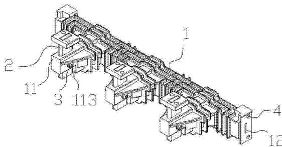
1. 一种带静触点的接线排,包括一根绝缘横梁,三个接线柱,其特征在于:绝缘横梁的同一侧有三个并排的凸起,所述的凸起均有一个竖向通孔,所述的凸起还有一个轴线贯穿所述竖向通孔的横向通孔,每个接线柱中部有一个横向通孔,每个接线柱上部留有与母线相连接的通孔,每个接线柱下部为静触点,三个接线柱各自穿过绝缘横梁凸起的竖向通孔,由螺栓穿过绝缘横梁凸起的横向通孔和接线柱中部的横向通孔把接线柱固定在绝缘横梁凸起处。
