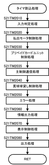
【図9-24】 払出制御タイマ割込処理
