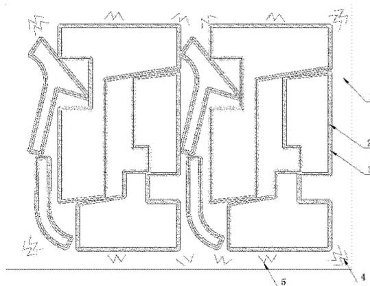
1. 一种刀模,包括模板和模切刀片,其特征在于所述模切刀片拐角处加装双 M 型护刀,直边处加装单 M 型护刀。
