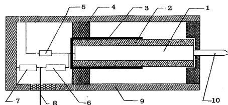
1.一种高压脉冲电阻分压器，其特征在于该分压器的外层屏蔽罩（9）为一个空心管状，在外层屏蔽罩（9）中设有第一级高压臂电阻（1），在第一级高压臂电阻（1）的外面套有绝缘套管（2），在绝缘套管（2）的一端套有套筒电极（3），绝缘套管（2）的两端分别由高压臂支架（4）支撑在外层屏蔽罩（9）内，在第一级高压臂电阻（1）的外端连接有高压输入极（10），第一级高压臂电阻（1）的内端连接套筒电极（3），在外层屏蔽罩（9）的底部与高压臂支架（4）之间设有第一级低压臂电阻（5）、第二级高压臂电阻（6）、第二级低压臂电阻（7）、分压器输出极（8）；其中第一级低压臂电阻（5）的一端接外层屏蔽罩（9），另一端接套筒电极（3）；第二级高压臂电阻（6）、第二级低压臂电阻（7）相串联后，其两端分别接外层屏蔽罩（9）和套筒电极（3），第二级高压臂电阻（6）、第二级低压臂电阻（7）的连接点接有分压器输出极（8），分压器输出极（8）的另一端引出外层屏蔽罩（9）外，在高压臂的低压端接入套筒电极（3），形成集流电容，提高阶跃响应的陡度，降低响应时间，调整套筒的长度或直径，可调节响应曲线的过冲。
