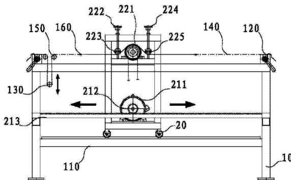
1. 一种小面积布料磨毛机,其特征在于,包括主支架和传动装置,所述主支架设置有导轨,导轨上设置有活动支架,所述活动支架通过所述传动装置与所述主支架相安装连接;所述活动支架上设置有磨毛装置,所述磨毛装置包括磨毛筒、第一包角调节机构和第二包角调节机构,所述磨毛筒设置于所述第一包角调节机构与所述第二包角调节机构之间。
