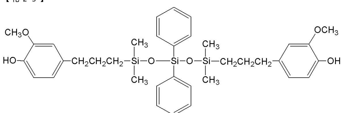
で表されるオルガノトリシロキサン（粘度 = 2,600 mPa·s、フェノール性水酸基当量 = 330）5.0 質量部、35 質量% - カプセル型アミン触媒のビスフェノール A 型エポキシ樹脂とビスフェノール F 型エポキシ樹脂の混合物（旭化成株式会社製の HX-3941 HP）1.0 質量部、平均粒子径 8.6 μm の球状アルミナ粉末 60.8 質量部、平均粒子径 3 μm の不定形アルミナ粉末 16.6 質量部、および式：
