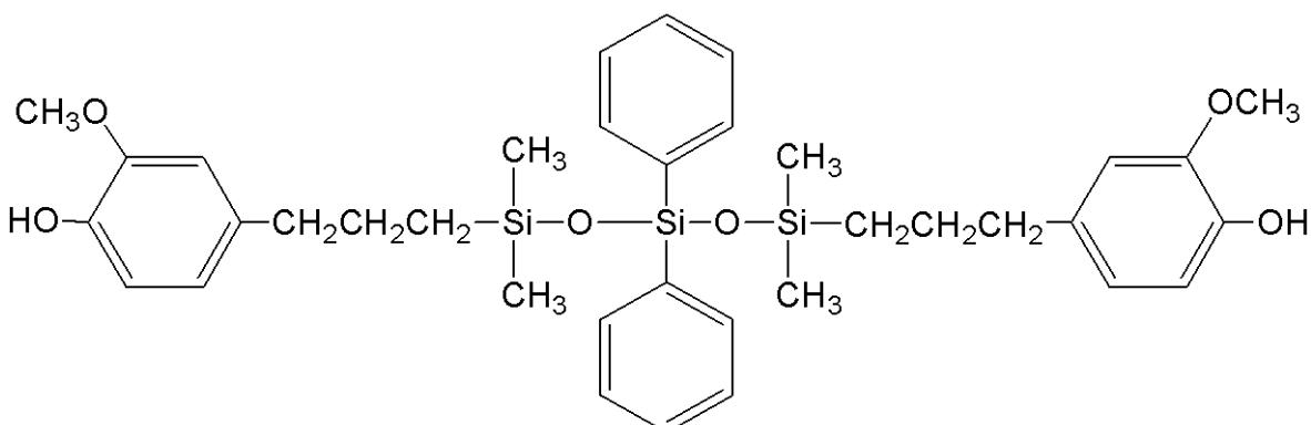
で表されるオルガノトリシロキサン（粘度 = 2,600 mPa · s、フェノール性水酸基当量 = 330）1.0 質量部、3.5 質量% - カプセル型アミン触媒のビスフェノールA型エポキシ樹脂とビスフェノールF型エポキシ樹脂の混合物（旭化成株式会社製のHX-3941HP）1.0 質量部、フレーク状銀粉末（福田金属箔粉工業株式会社製、50% 平
