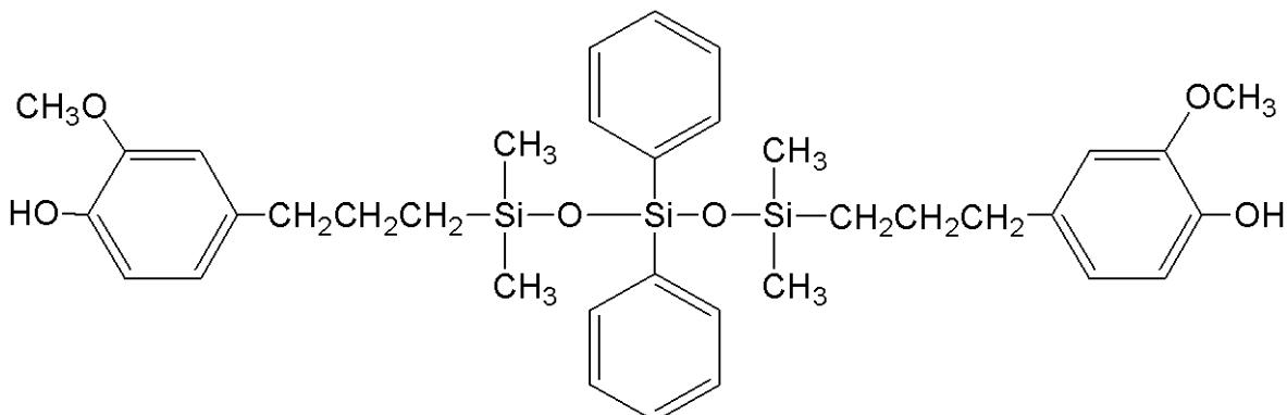
で表されるオルガノトリシロキサン(粘度=2,600mPa·s、フェノール性水酸基当量=330)2.0質量部、35質量% - カプセル型アミン触媒のビスフェノールA型エポキシ樹脂とビスフェノールF型エポキシ樹脂の混合物(旭化成株式会社製のHX-3941HP)1.0質量部、フレーク状銀粉末(福田金属箔粉工業株式会社製、50%平均粒径=9μm以下、タップ密度=4.2~5.4g/cm³、見かけ密度=2.7~3.4g/cm³)29.7質量部、平均粒子径8.6μmの球状アルミニナ粉末46.7質量部、平均粒子径3μmの不定形アルミニナ粉末12.7質量部、および式：
