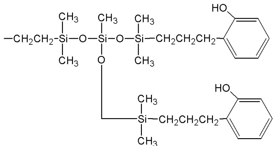
で表されるジメチルポリシリコサン（質量平均分子量 = 2,500、粘度 = 75 mPa・s）3.6質量部を混合して硬化性シリコーン組成物を調製した。この硬化性シリコーン組成物の粘度、硬化物の比重、複素弾性率、熱抵抗、および熱伝導率を測定した。これらの結果を表1に示す。
