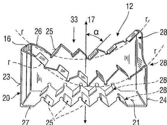
1. 一种用于内燃机(1)的废气设备(5)、尤其是用于机动车的内燃机的废气设备的混合和 / 或蒸发装置,包括一个支承体(20),该支承体在周边方向上包围所述装置(12)的横向于装置(12)轴向方向(17)延伸的、扁的可通流横截面,所述支承体(20)具有彼此相对置的第一和第二长的侧壁(21、22)和彼此相对置的第一和第二短的侧壁(23、24),所述短的侧壁(23、24)分别将各长的侧壁(21、22)彼此连接,在长的侧壁(21、22)之一上至少在一个轴向端部(26、27)上设置多个导向叶片(25),所述导向叶片分别向相对置的长的侧壁(21、22)方向突起并且相对于轴向方向(17)倾斜,其中,第一长的侧壁(21)的一个轴向端部(26、27)相对于第二长的侧壁(22)的在轴向方向(17)上设置在装置(12)同一侧的轴向端部(26、27)在轴向方向(17)上错开一个距离(d)。
