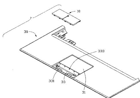
1. 一种笔记本电脑触控板按键固定结构，包括至少一按键与一上盖，其特征在于：上盖上方开设一凹槽，按键自上方固定于凹槽。
