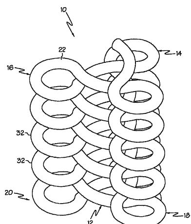
1. 一种医疗管状组件，包括四个聚在一起的医疗螺旋管，所述医疗螺旋管具有可插入患者体内的远端部分，其中，所述四个医疗螺旋管包括一个中心螺旋管和三个布置在中心螺旋管外部的周边螺旋管，所述四个医疗螺旋管由连续长度的导线缠绕而成。
