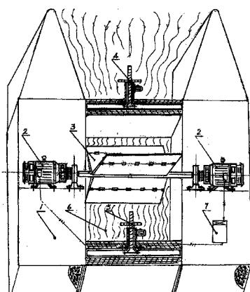
1. 一种悬浮Y型水轮发电机，两侧的增速发电机与中间Y型叶片水轮机同轴相连，其特征在于水流经可调水闸进入导水槽推动Y型叶片水轮机进而驱动联轴的增速发电机发电。
