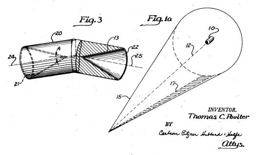
T. C. POULTER HIGH EXPLOSIVE DISK-SHAPED CHARGE FOR SEISMIC EXPLORATION 2,656,003
