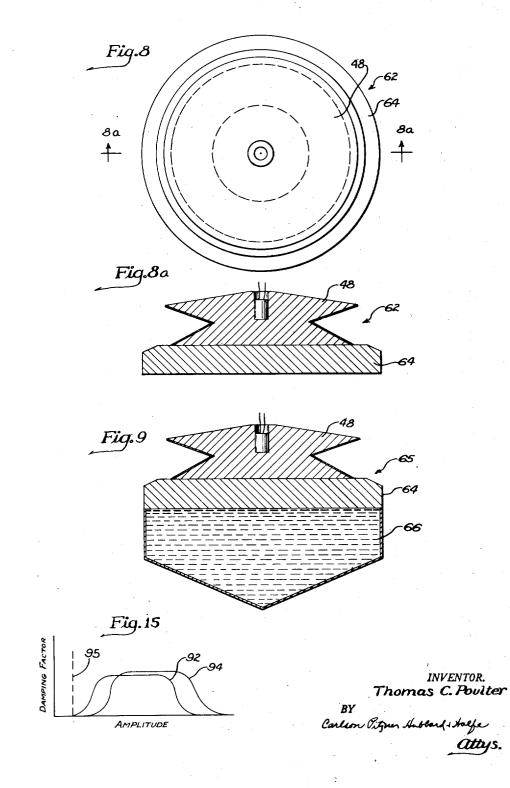
T. C. POULTER HIGH EXPLOSIVE DISK-SHAPED CHARGE FOR SEISMIC EXPLORATION 2,656,003
