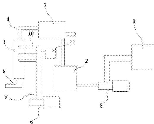
1. 一种泥水分离系统,包括旋流器(1)、污泥浓缩池(2)及污水脱泥器(3),旋流器(1)的上下两端设有泥水排出管(4)及磁粉排出管(5),旋流器(1)的一侧带有进料管,所述进料管与旋流器(1)上部的进料口连接,所述进料管的下端设有第一输送泵(6),污泥浓缩池(2)与污水脱泥器(3)之间安装有第二输送泵(8),其特征在于:所述旋流器(1)与污泥浓缩池(2)之间安装有磁性分离器(7);所述进料管包括进料主管(9)及上下并排与进料主管(9)径向连接的进料分管(10),进料分管(10)分别与旋流器(1)连接;所述进料主管(9)的下端与第一输送泵(6)连接,其上端安装有辅助输送泵(11),辅助输送泵(11)位于进料分管(10)与进料主管(9)的连接处。
