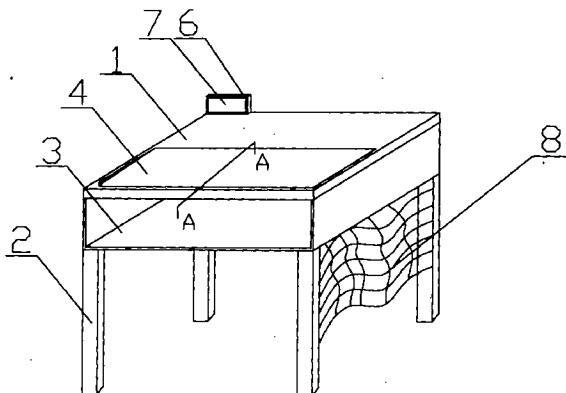
1. 一种大学生文明素养养成学习用书桌，包括设有桌腿的桌面，桌面下面设有书槽，其特征在于：桌面上设有斜面，斜面靠近桌面前侧边缘的一侧设有空槽，桌面后侧设有板体，板体两侧均设有卡片。
