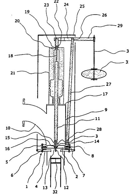
Die vorliegende Erfindung bezieht sich auf eine Einlaufeinheit für ein bis zu einem vorgegebenen Niveau zu füllendes Gefäß, umfassend einen Kegelventilsitz und einen Kegelventilkörper, der mittels einer Steuerung von einer Offenstellung in eine Schließstellung des Kegelventilsitzes verstellbar ist, um eine Flüssigkeitszufuhr über den Kegelventilsitz zu verbinden und jeweils abzusperren, wobei der Kegelventilkörper einen Stift aufweist.
