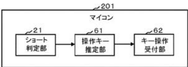
第2の実施形態によるマイコンの機能構成例
