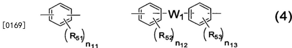
[0170] (式中,  $W_1$  为直接键合或2价有机基团,  $n_{11} \sim n_{13}$  各自独立地表示0~4的整数,  $R_{51}$ 、 $R_{52}$ 、 $R_{53}$  各自独立地为碳原子数1~6的烷基、卤基、羟基、羧基、或三氟甲基。)
