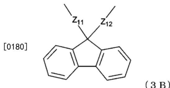
[0181] 所示的含芴基的基团的化合物。 $Z_{11}$  和  $Z_{12}$  各自独立地优选相同, 为单键或2价有机基团。作为  $Z_{11}$  和  $Z_{12}$ , 优选包含芳香环的有机基团, 优选例如式(3B1)所示的结构。
