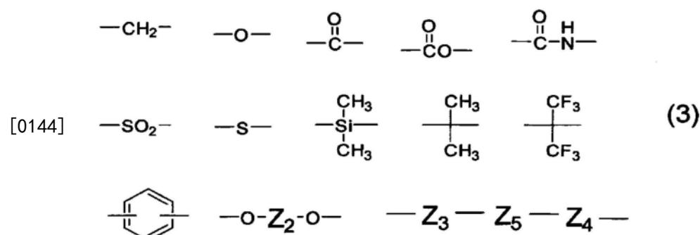
[0145] 其中,式中的Z<sub>2</sub>为2价有机基团,Z<sub>3</sub>、Z<sub>4</sub>各自独立地为酰胺键、酯键、羧基键,Z<sub>5</sub>为包含芳香环的有机基团。)
