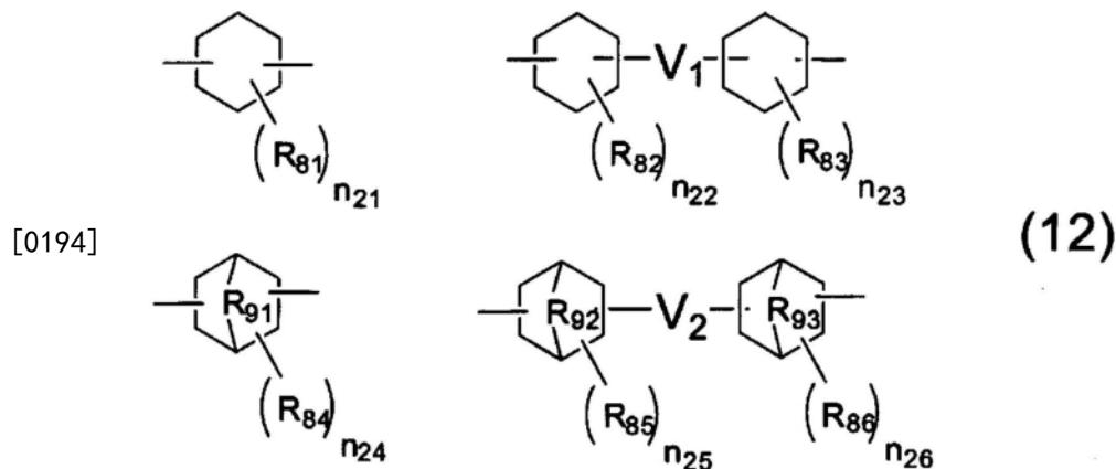
[0195] (式中,V<sub>1</sub>、V<sub>2</sub>各自独立地为直接键合或2价有机基团,n<sub>21</sub>~n<sub>26</sub>各自独立地表示0~4的整数,R<sub>81</sub>~R<sub>86</sub>各自独立地是碳原子数为1~6的烷基、卤基、羟基、羧基、或三氟甲基,R<sub>91</sub>、R<sub>92</sub>、R<sub>93</sub>各自独立地是选自由式:-CH<sub>2</sub>-、-CH=CH-、-CH<sub>2</sub>CH<sub>2</sub>-、-O-、-S-所示的基团组成的组中的一种。)
