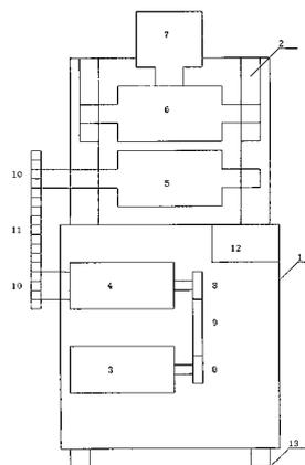
1. 一种对辊牵引机,包括机架(1)、电动机(3)、固定滚轮(5)、从动滚轮(6)和气缸(7);其特征在于:固定滚轮(5)固定在机架(1)上,由电动机(3)驱动转动;机架(1)上设有移动槽(2),从动滚轮(6)两端卡合在移动槽(2)内,由固定滚轮(5)带动转动;气缸(7)压在从动滚轮(6)上。
