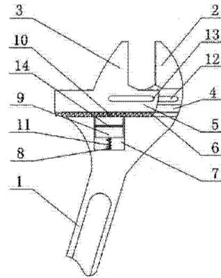
1. 活络扳手,包括手柄(1),设置在手柄(1)上的固定扳头(2)和与固定扳头(2)相配合的活动扳头(3),其特征在于:在固定扳头(2)上设置有导槽(4),在活动扳头(3)下侧设置有导槽(4)相配合的滑动块(5),滑动块(5)的底面设置有齿纹(6),在导槽(4)的下侧设置有空腔(7),空腔(7)内设置有定位销(8),定位块(9)套设在定位销(8)上,定位块(9)上设置有与滑动块(5)底面的齿纹(6)相啮合的齿纹(10),并且两齿纹啮合后活动扳头(3)不能向外移动,在定位块(9)下端的定位销(8)上还套设有弹簧(11)。
