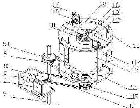
1. 一种防弹丝放线装置,它包括防弹丝放线转动框架,所述防弹丝放线转动框架内设置有防弹丝放线套筒座(1.11),防弹丝放线套筒座(1.11)外设置有防弹丝放线筒(1.12);防弹丝放线套筒座(1.11)上端内部设置有防弹丝放线导环支撑座,防弹丝放线导环支撑座上设置有横向布置的防弹丝放线导环(1.13);
