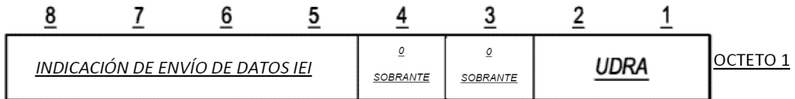
FIGURA 9.9.4.29.1: ELEMENTO DE INFORMACIÓN DE INDICACIÓN DE ENVÍO DE DATOS
