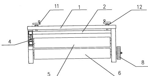
1. 冲床自动离合送料器，主要由盖板、调节压板、立柱、滑块、主动胶轮、从动胶轮、自动离合器，调节底座、调节手轮、过桥轮、轴承所组成，其特征是：在长方形送料器上部装有长方形盖板，盖板上装有调节螺丝，盖板两头用螺丝与梯形立柱顶端连接固定，盖板下面装有长方形调节压板，压板两头凹槽又装在立柱上部中间，压板下面两头装有弹簧座，弹簧座上装有调节弹簧，弹簧下端又装在长方形滑块上部弹簧座上，滑块又装在立柱上部中间导轨中，两滑块中间内侧装有从动胶轮轴和轴承，从动胶轮下面装有主动胶轮，主动胶轮轴和轴承又装在立柱下部中间内侧，主动胶轮轴的一头伸出立柱外面，在轴头上装有自动离合器，在离合器上面装有过桥轮，过桥轮与冲床滑块上齿条或连杆连接传动，送料器底部又装在调节底座上，调节底座又装在冲床工作台上。
