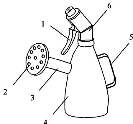
1. 新型两用喷壶,其特征是:在壶体的壶口处安装有喷头,在喷头上设置有按压杆,在壶体的侧面连接有与壶体连通的连通管,在连通管端口处连接有花洒头,在壶体的另一侧面连接有把手。
