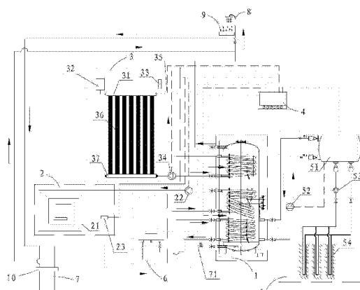
1. 一种真空管太阳能、地热、燃气互补组合式供暖供热系统，其特征在于，包括保温水箱总成、真空管太阳能总成、供暖环路总成、地源热泵总成、燃气壁挂炉总成、控制器总成、进水管路、用水末端、热水收集器和余热交换装置；
