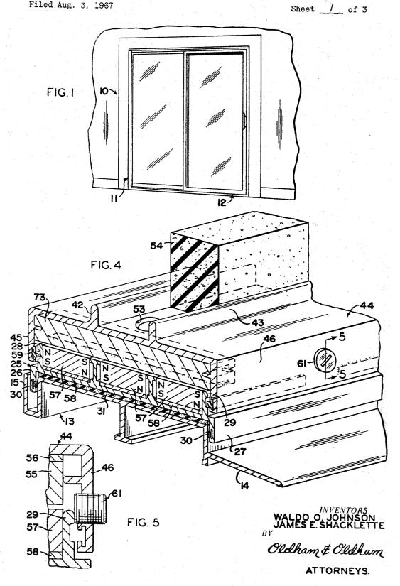
CONTROLLED POSITION SLIDING DOOR, WINDOW, PANEL OR THE LIKE
